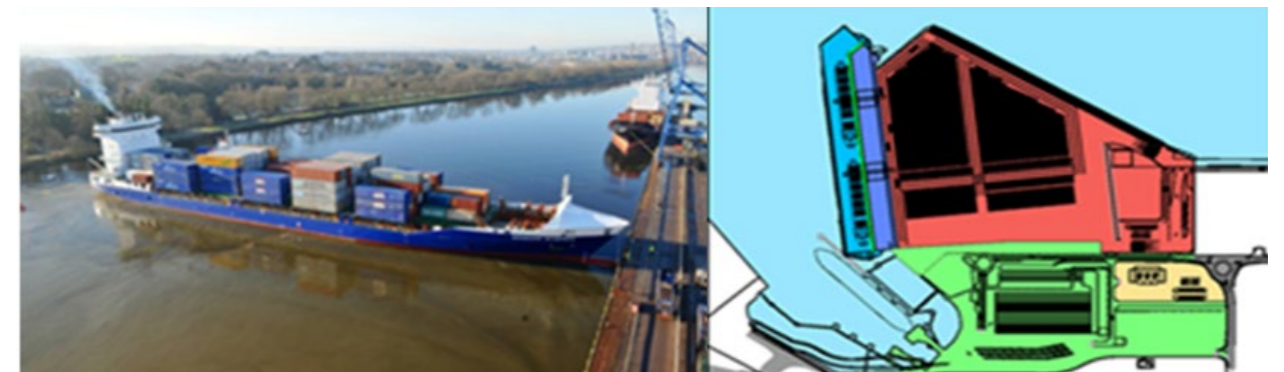
Pictiúr 3: Léirítear anseo na srianta a bhaineann leis na saoráidí Lo-Lo atá ann cheana féin i gCríochfort Coimeádán Tivoli (doimhne an uisce, leithead le haghaidh bhogadaíl an tsoithigh, acmhainneacht an chríochfoirt ar thaobh na talún).
